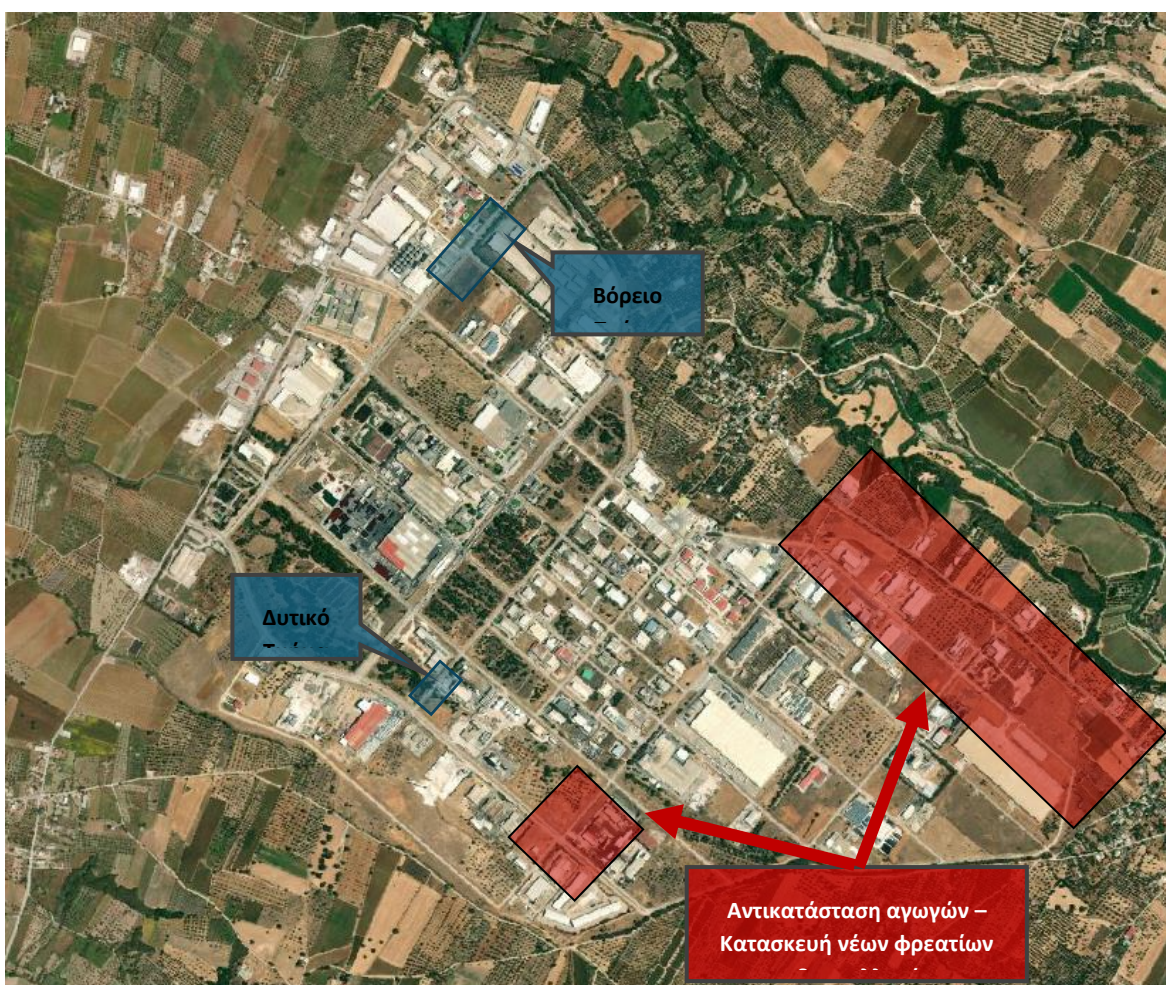
Σχήμα 1. Απόσπασμα δορυφορικής απεικόνισης, όπου με μπλε πλαίσιο απεικονίζονται οι περιοχές εμφάνισης πλημμυρικών φαινομένων, που μελετώνται στην παρούσα μελέτη καθώς και οι περιοχές αντικατάστασης των αγωγών και κατασκευής των φρεατίων υδροσυλλογής (κόκκινο φόντο).
